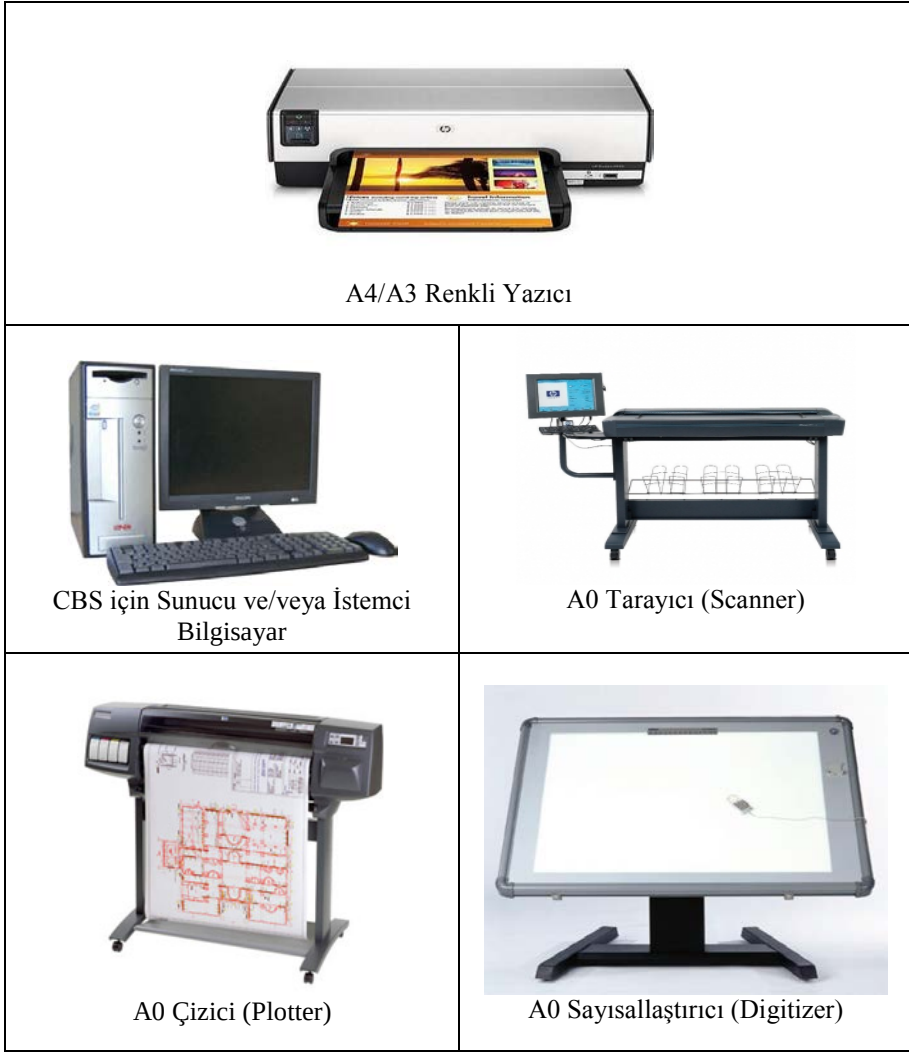
Şekil 3.2 CBS Çalışmaları için Gerekli Bazı Donanımlar
